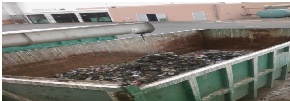
Figure 8 : le vise déversant les déchets dans la benne
